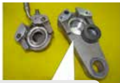
往復するピストン部の O/H と、カップ O リング点検
