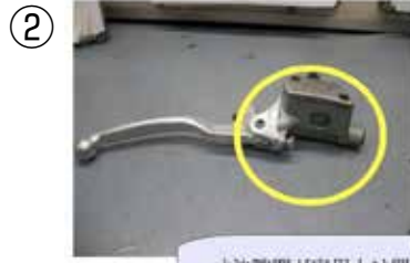
② 寸法隙間が実用上は問題ないレベルに、見かけはどうあれ、溶接修理出来ました。
